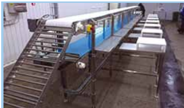
Конвейерная линия для рыбной продукции: для упаковки нарезанной охлажденной рыбы
