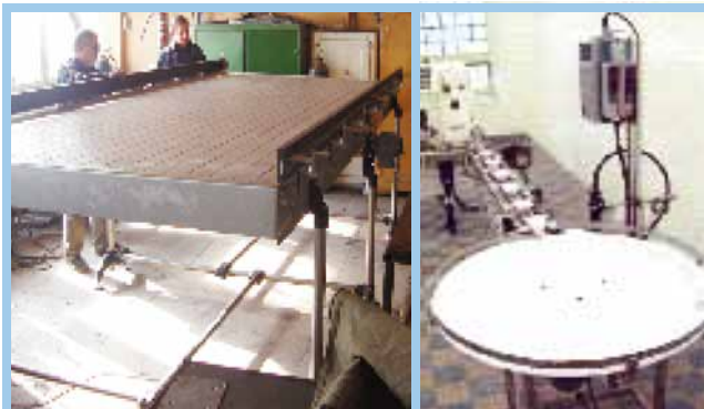
Стол накопительные: линейно-перемещающие и вращающиеся с собственным приводом или с приводом электродвигателя конвейера
