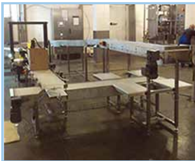
Конвейерная система с использованием модульных лент для упаковки и транспортировки гофрокоробов и ящиков с продукцией
