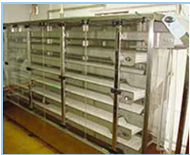
Многоуровневая конвейерная система с использованием модульных лент для охлаждения различного вида продукции
