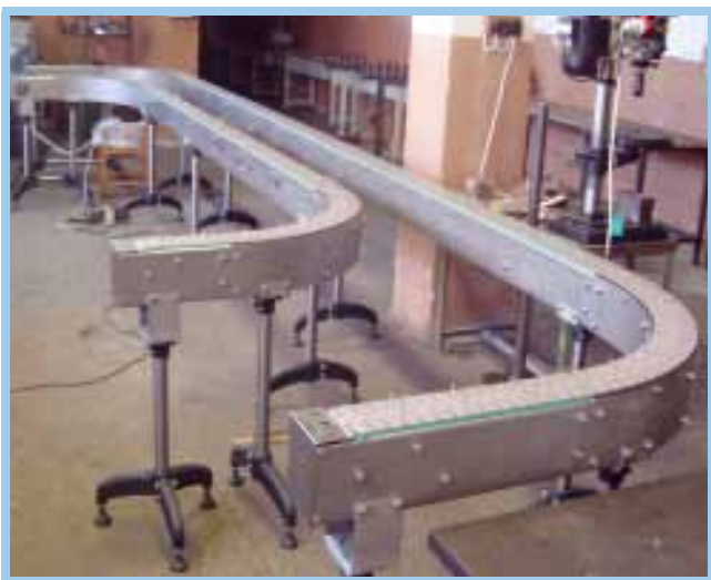
Цепные (пластинчатые) конвейеры в различных вариантах исполнения: одноручьевые или многоручьевые, прямые, наклонные и поворотные; материал изготовления пластин: пластмасса или нержавеющая сталь
